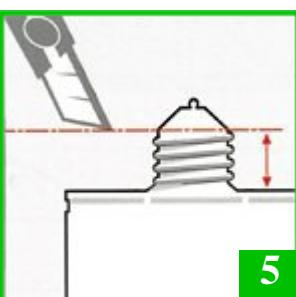
Вскройте тубу с герметиком, вставьте в пистолет для герметика.
