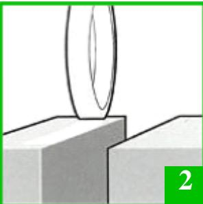
С обеих сторон защитим лицевые стороны кромки конструкции малярным скотчем для получения аккуратного шва. Тщательно прогладим скотч во избежание образования пустот между поверхностью и скотчем.
