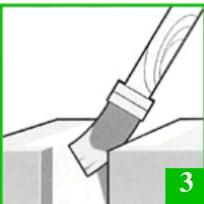
Если степень адгезии герметика с поверхностью недостаточна, может возникнуть необходимость в дополнительном грунтовании поверхности. Для этого использовать смесь из Acryl 160 и воды в пропорц. 1:1 или 1:2, обработать контактную поверхность и дать хорошо просохнуть.
